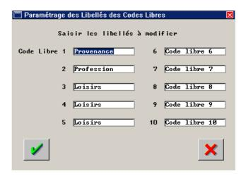
Par défaut les lignes sont numérotées de « Code libre 1 » à « Code libre 10 ». Indiquer éventuellement un libellé spécifique à chaque ligne. Cette fonction doit être couplée avec le paramétrage précédent d'indice de position : par exemple les codes concernant la provenance du client doivent être en indice de position 1 (BO1, OP1, P11, P21, etc.).
